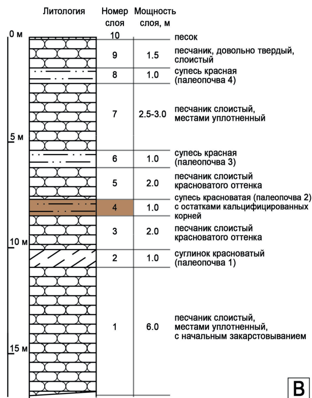
Рис. 2. Сводный разрез отложений плейстоцена Кенитра 1 (В) в клифе (А, Б) на левом берегу реки Себу, в городе Кенитра, напротив парусного клуба (по материалам, предоставленным проф. Н. Хамуми)
